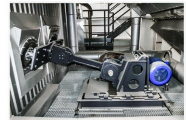
Pogonski mehanizam vibrirajuće rešetke
